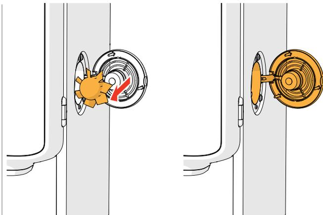
5. limpie el rotor del ventilador con *agua caliente y jabón*
